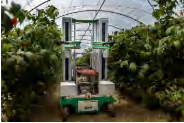
图7. 可调节的水果采摘机器人
